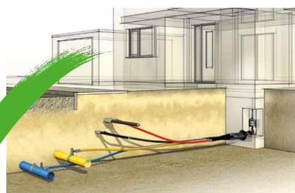
Die sichere und korrekte Ausführung einer Mehrsparten-Hauseinführung am Beispiel der Reihen-Ausführung Quadro-Secura® Basic R4+ für Gebäude ohne Keller und Quadro-Secura® Nova 1/breit für Gebäude mit Keller.
