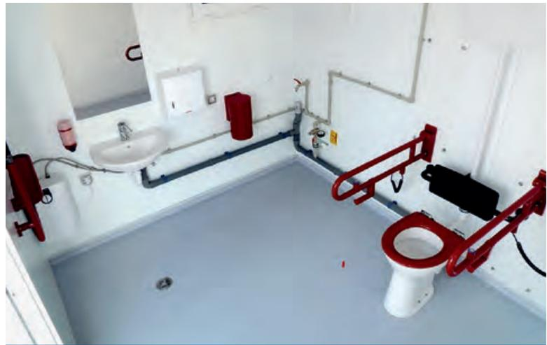
Innenansicht barrierefrei Ausführung nach DIN 18040-1
